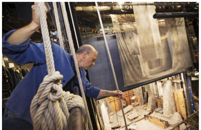
*Die 52 E-Züge und 46 Handzüge überwinden eine Hubhöhe von 25 Meter und können je 400 Kilogramm heben.*
